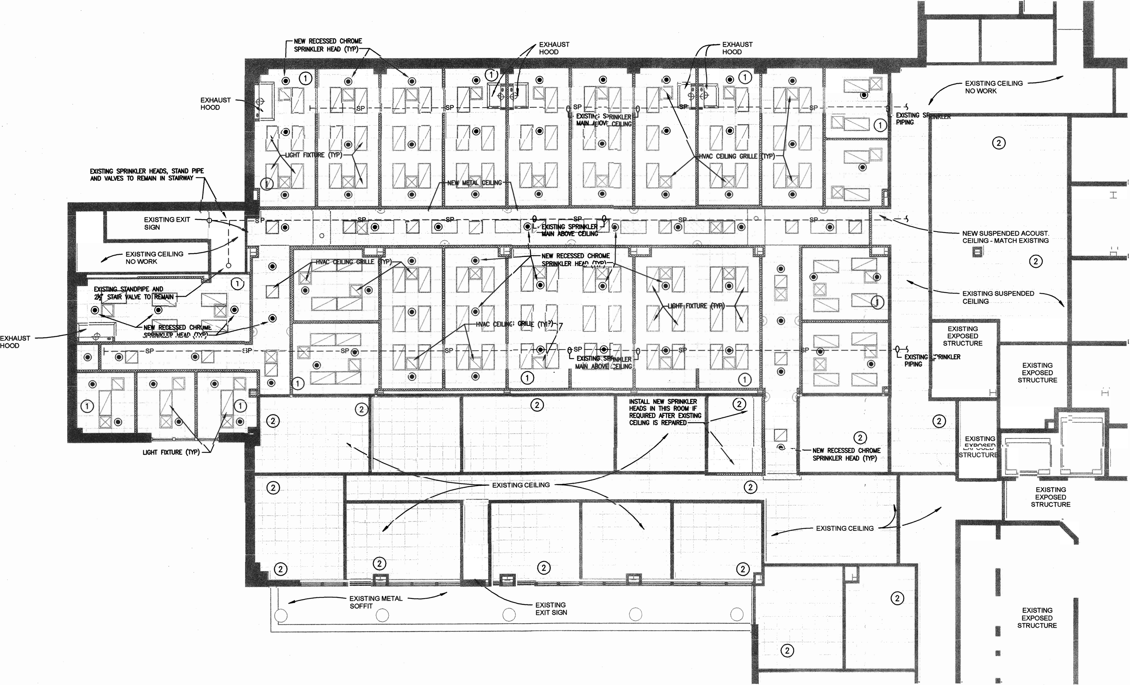
1 FIRE PROTECTION PLAN SCALE: 1/8" = 1'-0"
