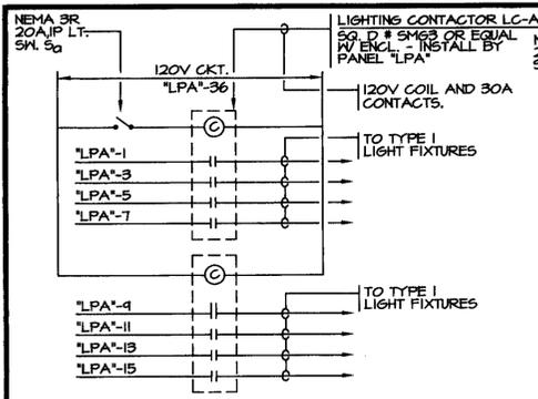
LC-A CONTROL WIRING DIAG.
