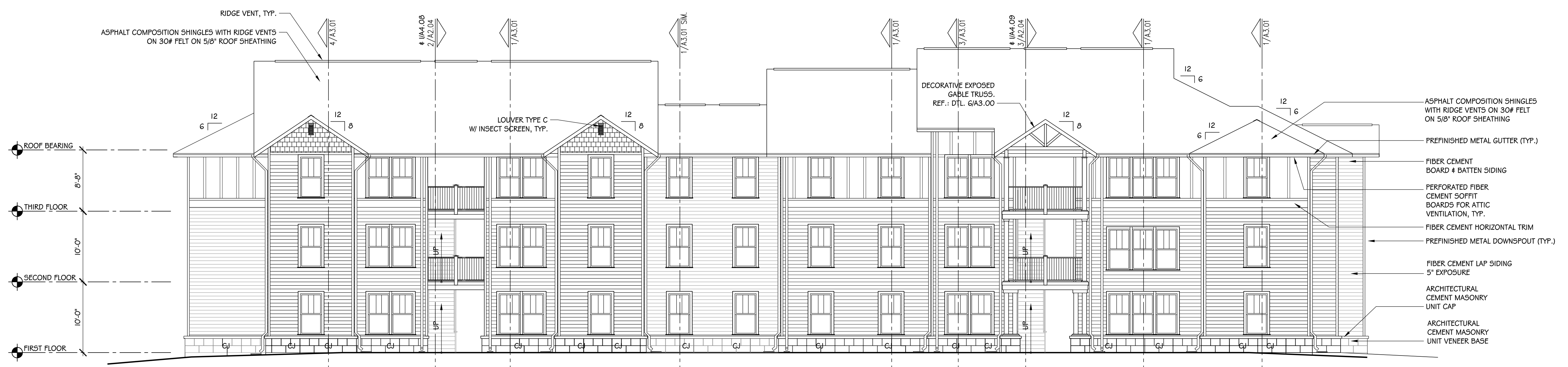
NORTH ELEVATION SCALE: 1/8" = 1'-0"
